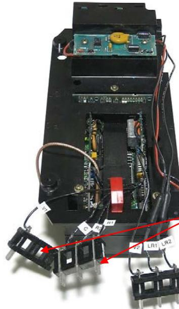
Retirez les connecteurs des 3 blocs à bornes en
